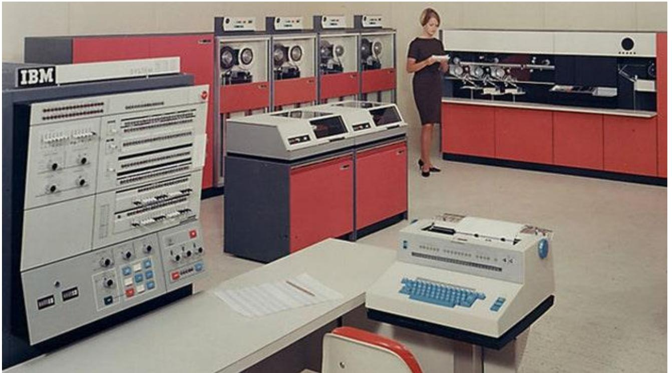
Photo d'un model 360/40 avec sa machine à écrire pour le piloter. On peut voir aussi 2 disques 2311, 4 bandes magnétiques et un lecteur de chèque.
